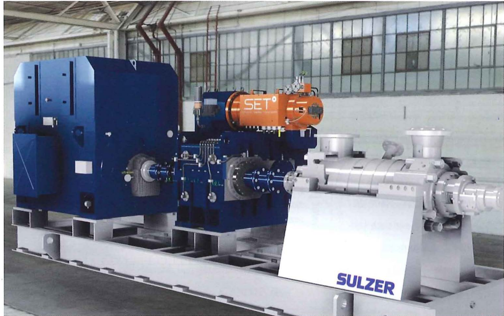
Abb. 1 Der vorhandene Motor, das neue elektro-mechanisches Differentialsystem zur Drehzahlregelung und die Kesselspeisepumpe als kompakte und höchst effiziente Einheit.
