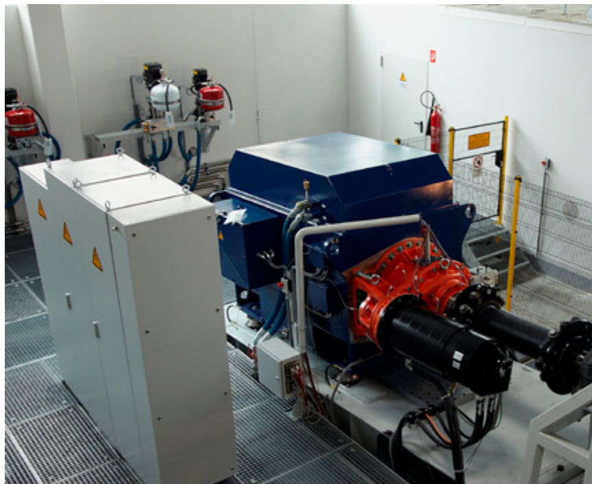
Bild 3: 3.0 MW DSgear-set® am Prüfstand in Klagenfurt
